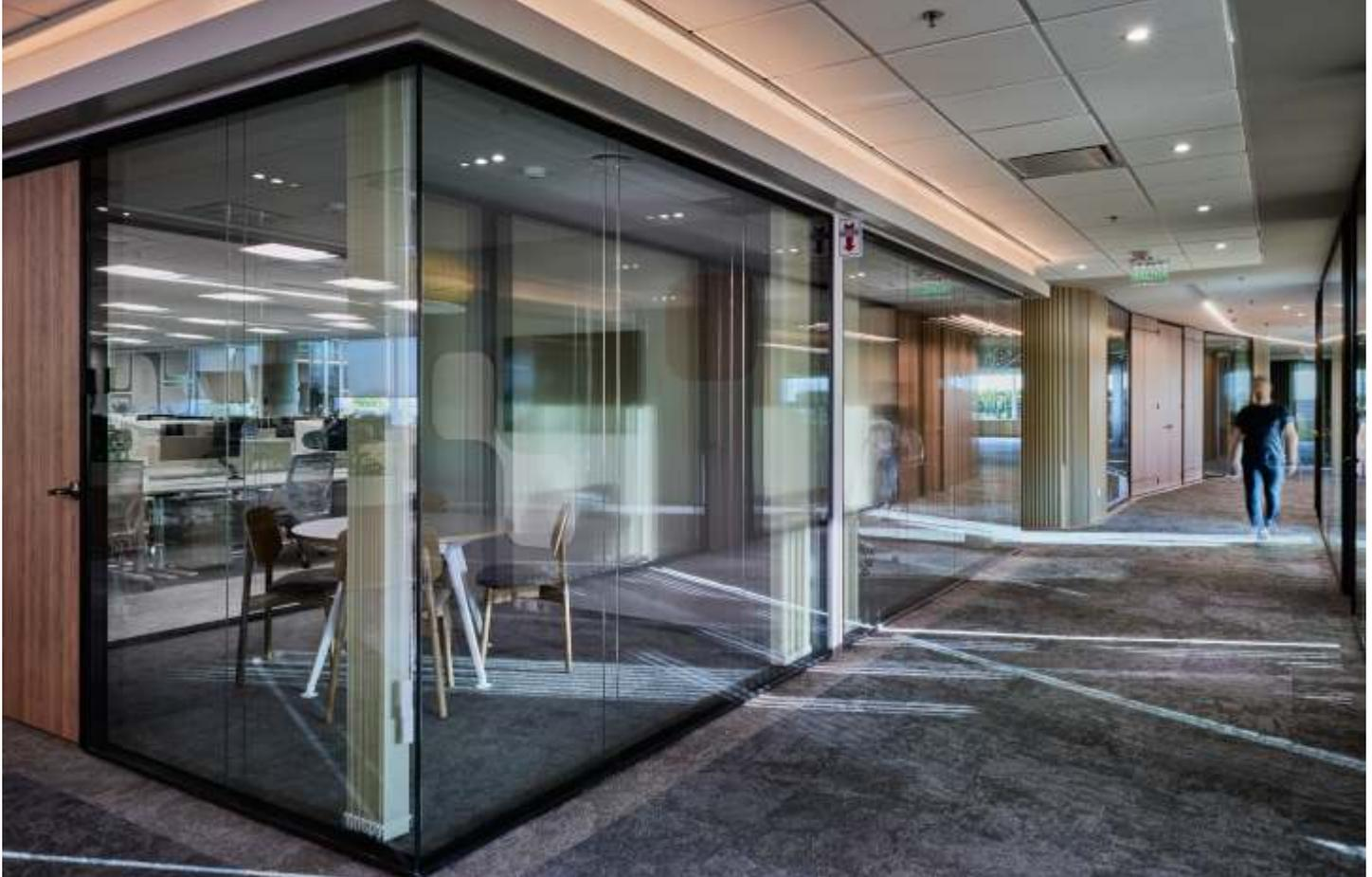
**AWD Flat Box** es un sistema de paneles divisorios, con doble plancha de vidrio y sin junta a la vista. De colocación rápida y efectiva, permite una colocación precisa y sencilla, siendo el material totalmente recuperable para su fácil reconfiguración.
